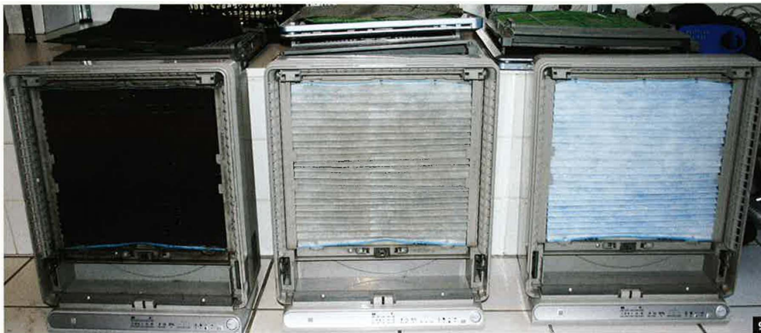
Abb. 9: Links ist ein Luftreinigungsgerät nach zweiwöchigem Einsatz in einer „Fogging“-Wohnung zu sehen, in der Mitte eines nach dreiwöchigem Einsatz in einer Wohnung ohne „Fogging“ und rechts zum Vergleich ein neuer Filter.
