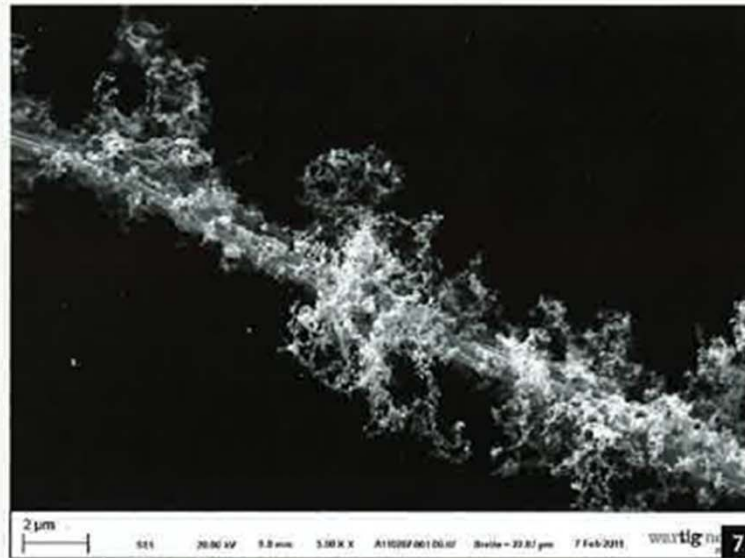
Abb. 7/8: Rasterelektronenmikroskopische Aufnahmen eines rußähnlichen Partikels (7) und eines wachsartigen Partikels (8), wie sie in Fogging-Ablagerungen vorkommen
